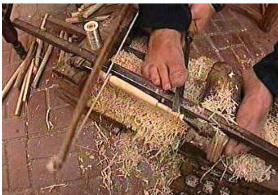
Рис. 2.10. Примітивний дерево-обробний верстат від лучкового приводу, [20* ].
