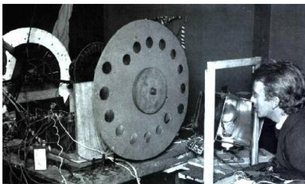
Рис.12.20. Телевізійна система Дж. Берда, [69].
