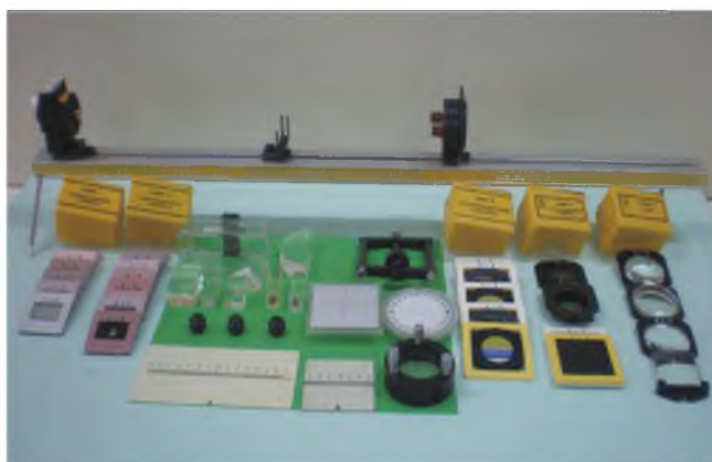
Рис. 1. Комплект оптична міні-лава та джерело випромінювання
