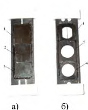
Рис. 3 Набір тест-об'єктів: а) тест-об'єкт № 1 складається з: 1 – широкої щілини, 2 – вузької щілини, 3 – щілини Юнга (подвійна); б) тест-об'єкт № 2 складається з: 4 – біпрізм Френеля, 5 –вікна, 6 – тонкого екрана („нитка”)
