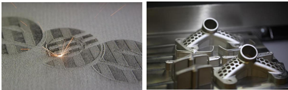
Рис. 3. Технологія прямого лазерного спікання металів
