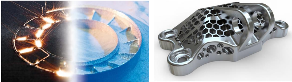
Рис. 1. Технологія селективного лазерного плавлення
