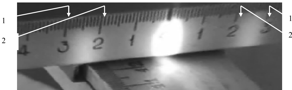
Рис. 1. Використання червоного (1) і синього (2) світлодіодів для визначення довжин хвиль різних ділянок спектра оптичного діапазону.
