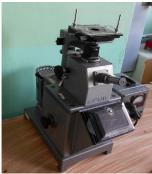
Рис. 7. Мікроскоп МИМ-7 Рис. 8. Схема мікроскопа МИМ-7 Рис. 9. Набір змінних приладів
