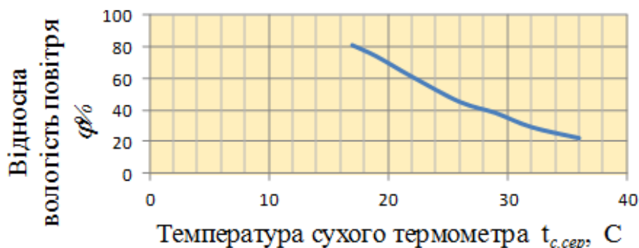
Рис. 2. Графік залежності відносної вологості повітря від температури.
