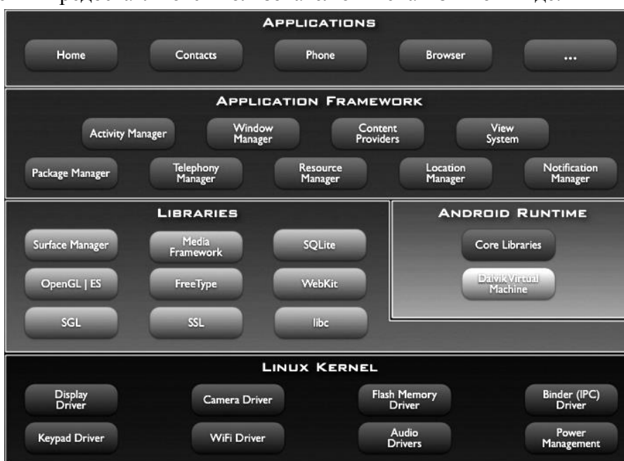
Рис. 1. Архитектура платформы Android
