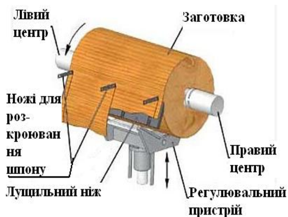
Рис.11.1. Схема верстата для виробництва луценого шпону.
