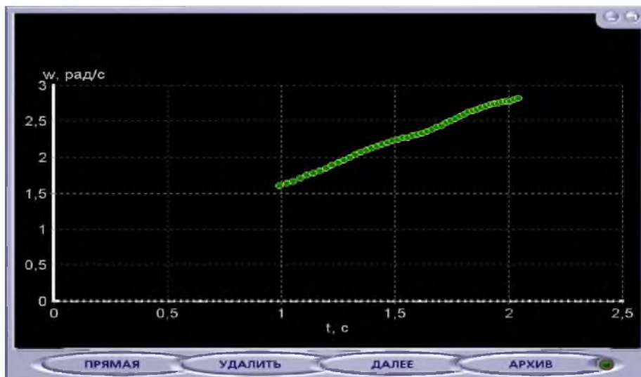
Рис.3. Частина графіку залежності кутової швидкості від часу, що відповідає зростанню кутової швидкості
